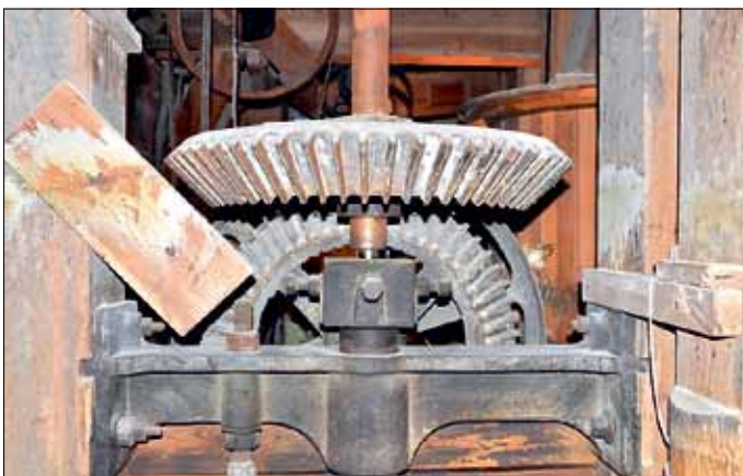
Interessante Mühlentechnik: Absackvorrichtung mit Bodenstein
